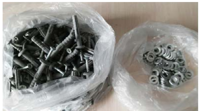
Саморезы с дюбелями и шайбами для крепления мембраны к фундаменту, длина саморезов 4 см, шайба небольшая, чтобы помещалась между зубчиками мембраны.
